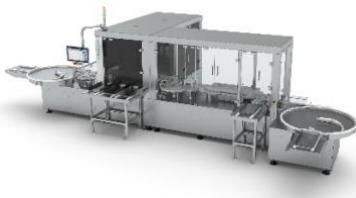
Die neue Inspektionsplattform AIM9 von Syntegon kombiniert visuelle Inspektion und Dichtigkeitsprüfung mit einer Ausbringung von bis zu 600 Vials pro Minute.
