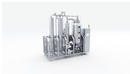
Bild 2: Der Druckauflöser BLK Rapidsolver Solids+ erreicht einen Trockensubstanzgehalt von bis zu 86 Prozent.
