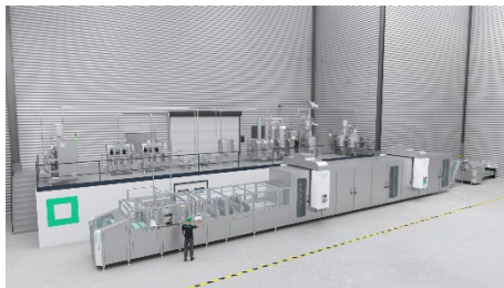
Bild 1: Die Turnkey-Lösung NutraFlash umfasst Küche, Gießanlage und Produktnachbehandlung zur puderlosen Herstellung funktioneller Gummi- und Geleeprodukte.
