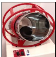
Fig. 3: Rhönräder mixer (5.3 l)
